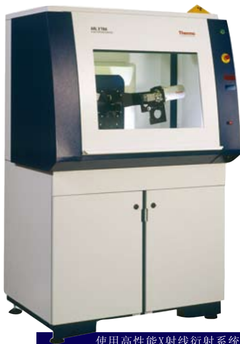
使用高性能X射线衍射系统进行水泥以及相关物相的鉴定和定量分析
